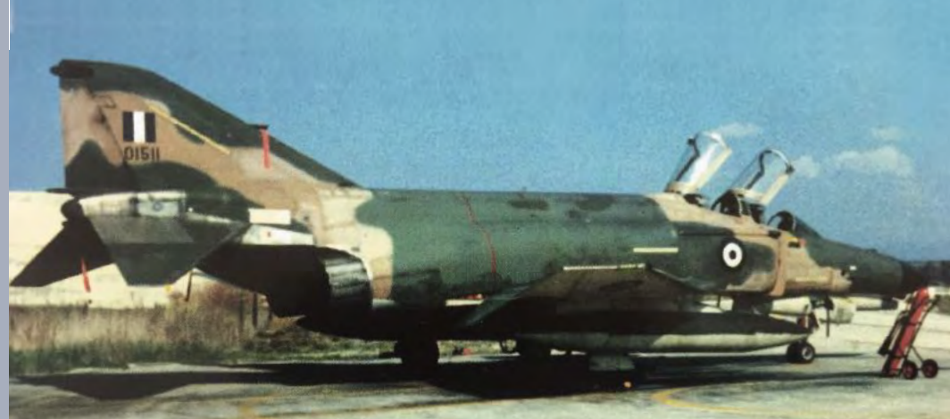
Πρώτο αεροσκάφος που απέκτησε το σύστημα αυτοπροστασίας DIAS είναι το 01511 της 339 Μ στην ΕΑΒ. Στα υπόλοιπα αεροσκάφη, το σύστημα τοποθετήθηκε στην ΜΣΒ της 117 ΠΜ.
